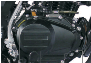
سطح کمترین سطح بیشترین درپوش مخزن روغن گیج روغن
