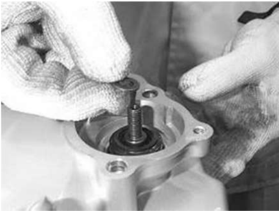
پروانه پمپ آب
