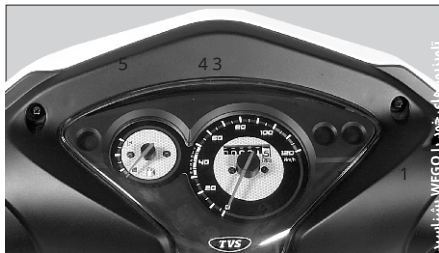
مونتاز سرعت سنج برای نسخه درام و دیسک WEGO
